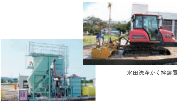
水田カドミウム除去装置
