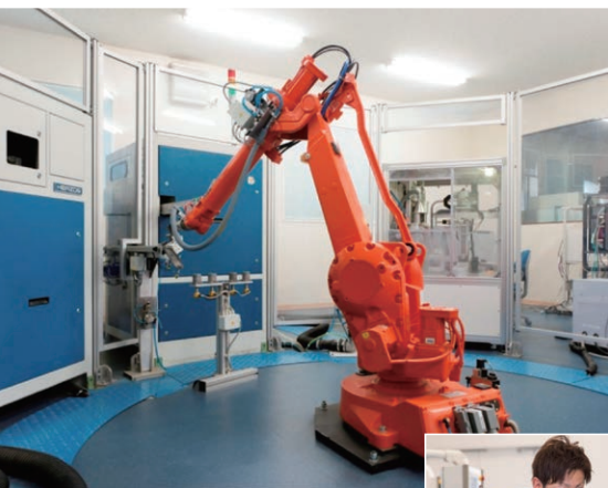
XRD/リートベルト解 析を組み込んだオンラ イン自動分析
