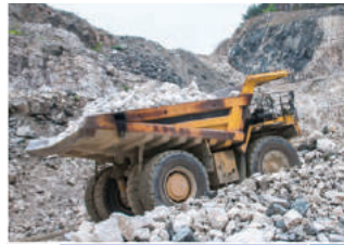
採掘現場から骨材原石を運搬するダンプカー
