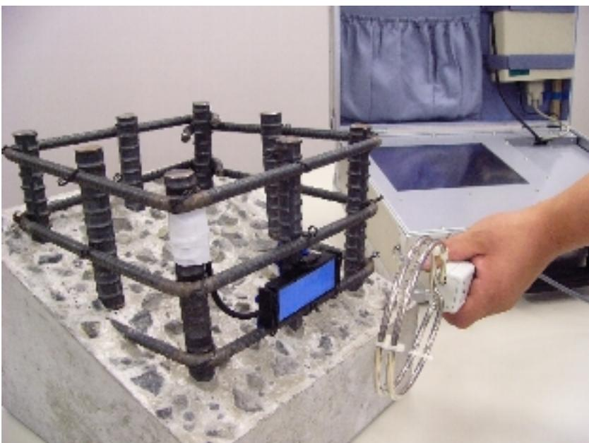
※センサ部（鉄筋上の白色テーピング部）の情報を RFID タグ（青色）から、制御 PC を搭載した可搬型リーダライタにより計測します
