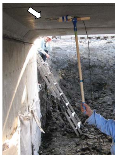
掘削後のひずみ計測状況 (アンテナ(矢印)を用いてひずみ値の読取)
