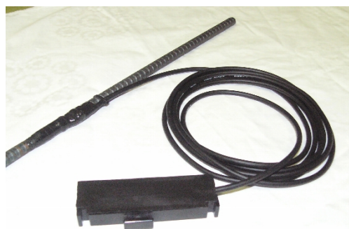
鉄筋に取付けられているひずみ センサ部と RFID タグ
