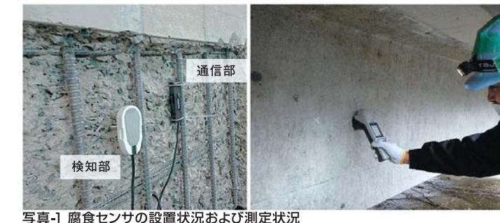
写真-1 腐食センサの設置状況および測定状況
