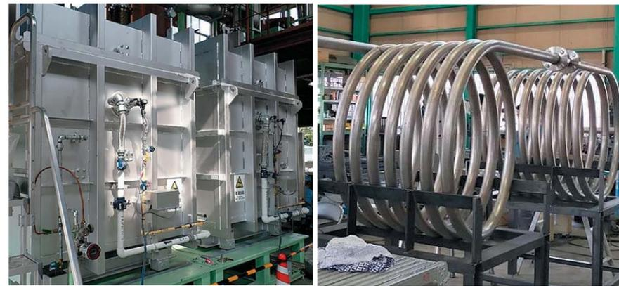
写真-1 ラボ試験機加熱炉外観(左)および加熱管(右)
