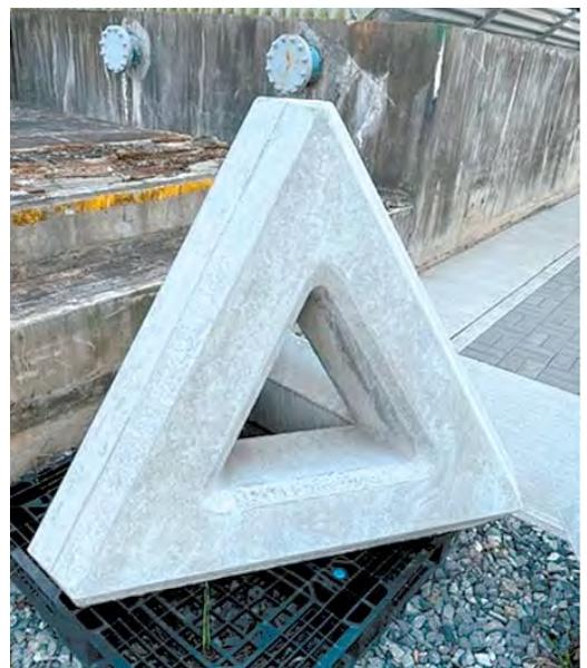
写真-1 カーボキヤッチスラリーを適用したコンクリート消波ブロック
