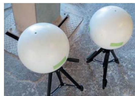
写真-2 リファレンスボール
