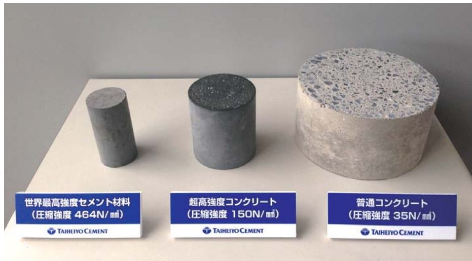
写真-2 同一荷重を受け持つことのできるコンクリートの断面積の比較
