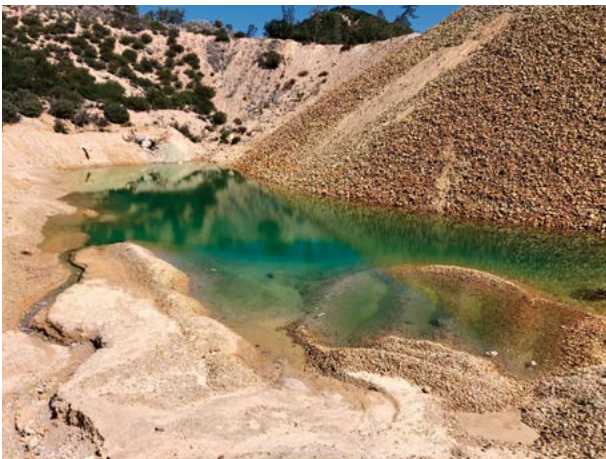
カルポルトランド社のロッキーキャニオン骨材採石場における雨水と湧水の集水・貯蔵状況
