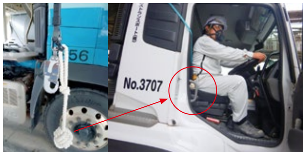
セーフティーブロックにボール状のものを取り付け → 乗車時に違和感があり墜落防止用器具の取り外し忘れに気づく
