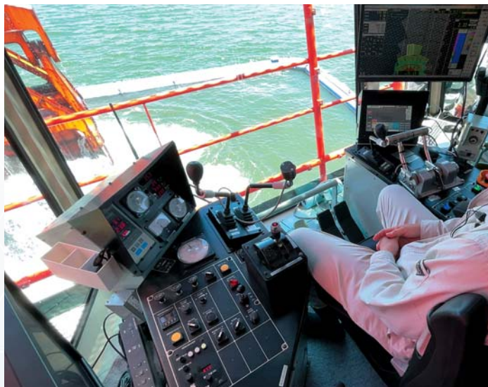
写真-1 自動運転中の起重機船のクレーン操作室
