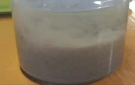
写真-6 セメントミルク水中打設状況
