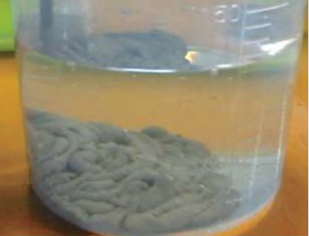
写真-7 レコキープLR-2Nの水中打設状況
