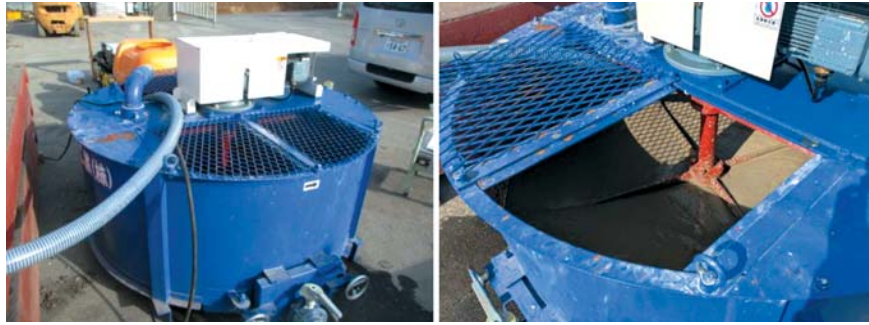
写真-10 パン型アジテータの全体写真とレコキープLR混合状況
