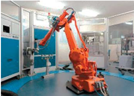
図-2 太平洋セメント工場のオンライン分析システム 6)
