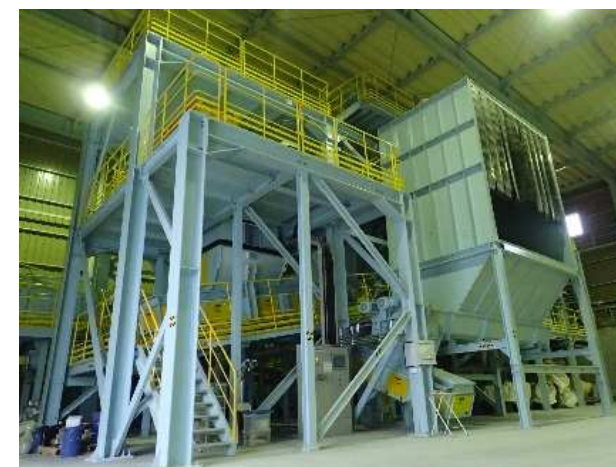
都市ごみ焼却灰からの貴金属回収実証試験設備 (大船渡工場)
