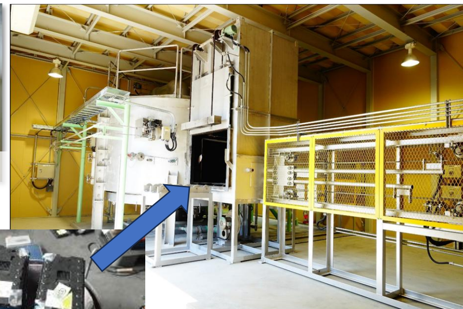
リチウムイオン電池の無害化処理
