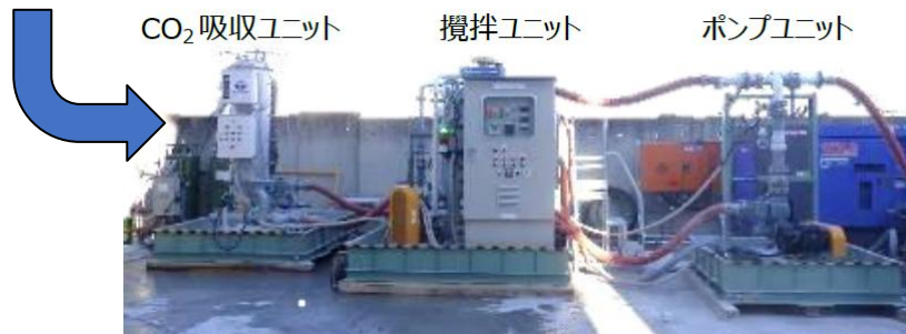
カーボキャッチ技術によるCO 2 固定
