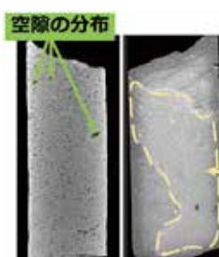
非破壊で改良体内部を可視化
