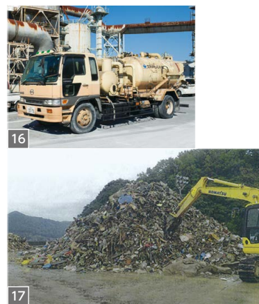
16：水害後の復旧作業に活躍した汚泥吸引作業車 17：水害時に集積したがれき
