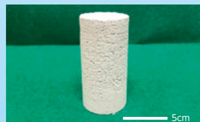
開発中のカルシウムカーボネートコンクリート供試体
