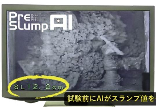
練混ぜ後のコンクリートのスランプ予測システム「PreSlump AI」のモニター画面:
