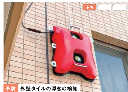
予防 外壁タイルの浮きの検知
