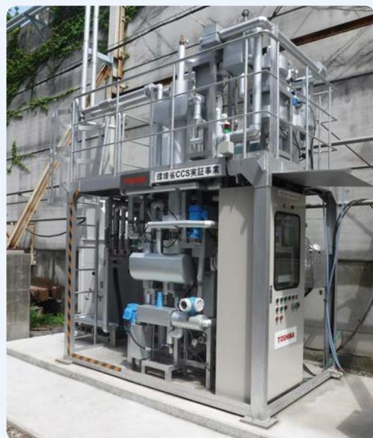
CO<sub>2</sub>を分離・回収するテストプラント（藤原工場）
