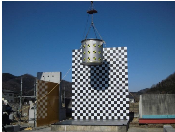
写真4 落下衝撃試験状況
