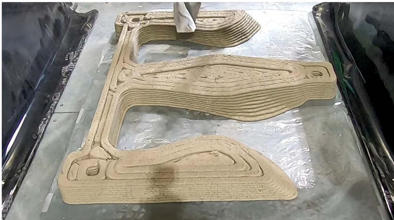
(写真①) 「T-3DP®」 \*<sup>2</sup>による造形の様子
