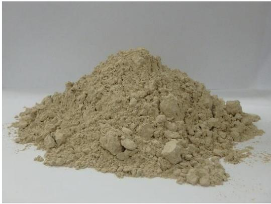
写真1 「カーボフィクスセメント」の外観
