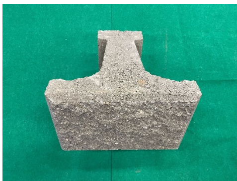
写真1 カーボフィクスセメントを使用した積みブロック
