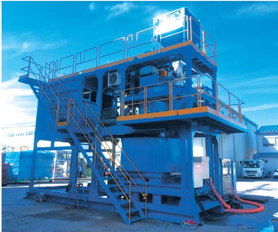
写真-1 専用ミキシングプラント
