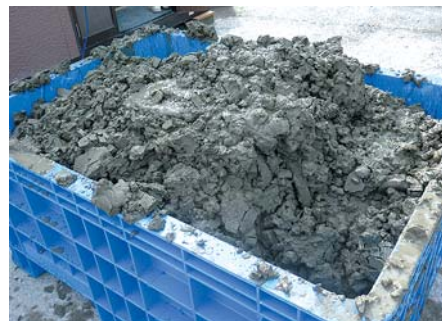
写真-2 生コンスラッジケーキ
