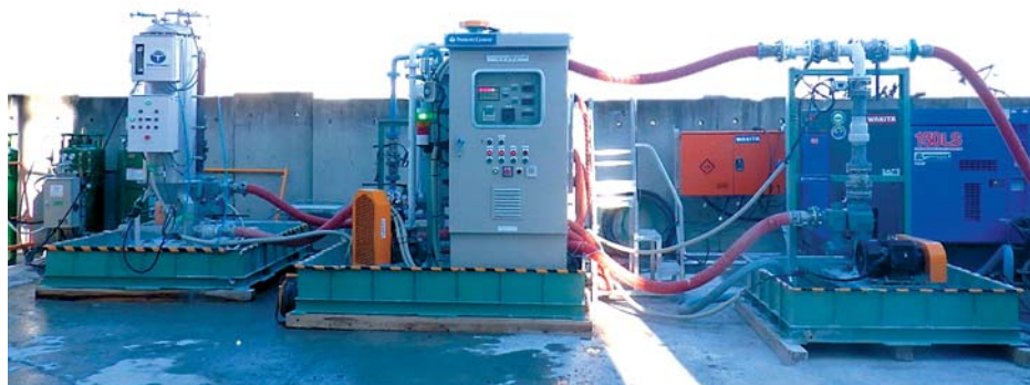
写真-1 カーボキャッチモバイルの全体像(左からCO 2 吸収ユニット、攪拌ユニット、ポンプユニット)
