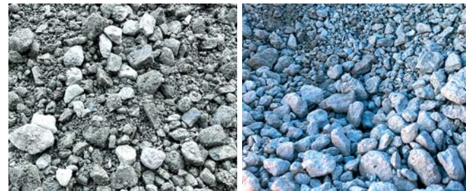
写真-3 路盤材の外観(左:粒度調整砕石、右:CO 2 を吸収させた廃コンクリート)
