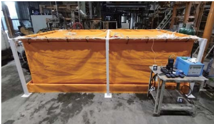
写真-5 簡易炭酸化養生槽の外観
