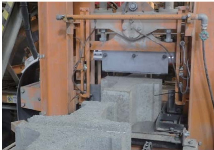
写真-4 ブロックの割裂状況
