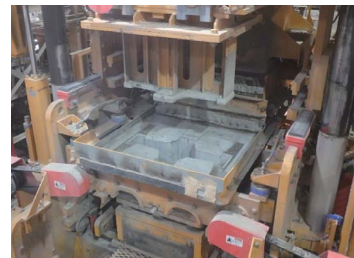
写真-2 加圧振動成形機での成形状況
