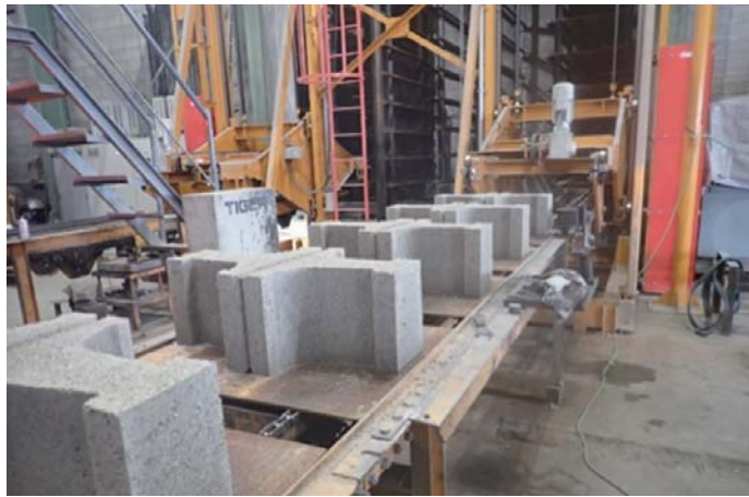
写真-3 成形後のブロック
