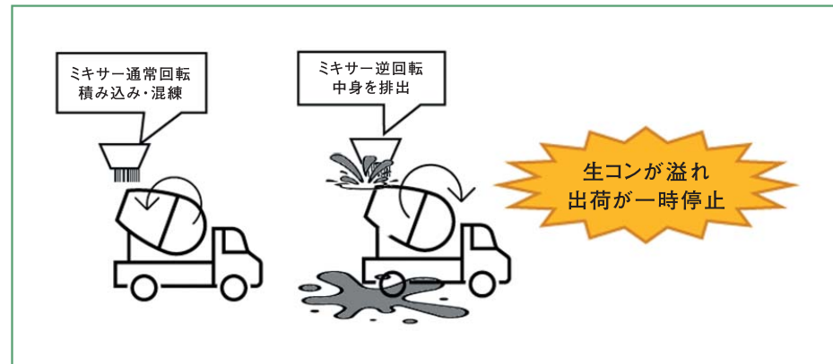
図-4 ミキサー車から生コンが溢れるイメージ
