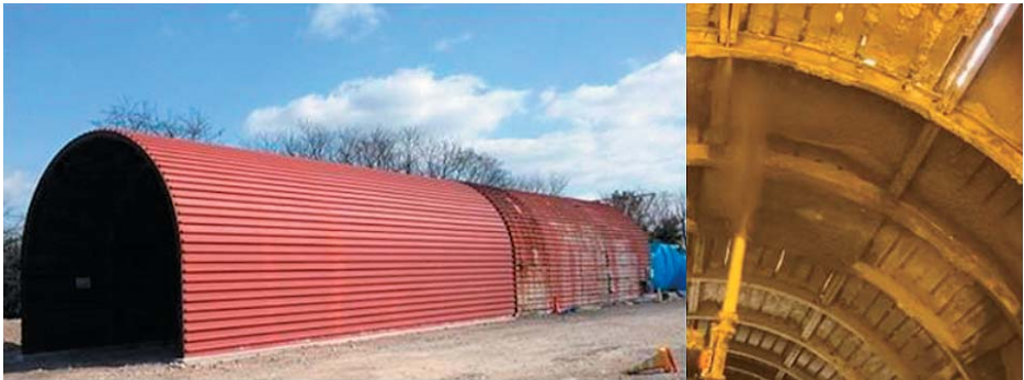
写真-3 模擬トンネル外観およびトンネル天端部吹付け状況
