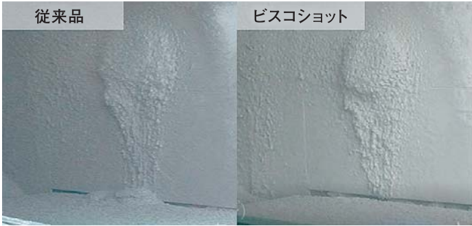
写真-4 従来品およびビスコショットの付着状況
