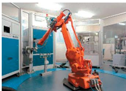
図-2 太平洋セメント工場のオンライン分析システム 6)
