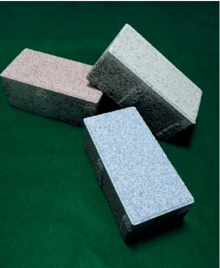
写真-6 カーボフィクスセメントを使用したインターロッキングブロック
