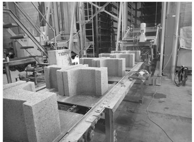
Fig.8 SP blocks after molding (成形後の SP ブロック)
