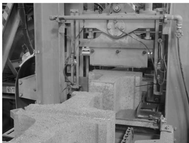
Fig.10 Splitting status of SP block (SP ブロックの割裂状況)
