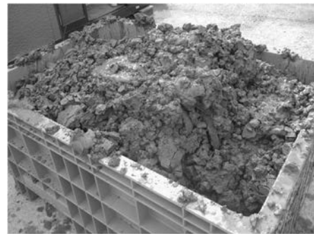
Fig.3 Dehydrated concrete sludge (コンクリートスラッジの脱水ケーキ)
