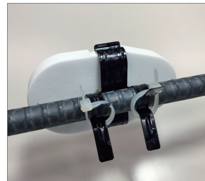
鉄筋径に合わせた設置器具を用いた鉄筋への設置。
