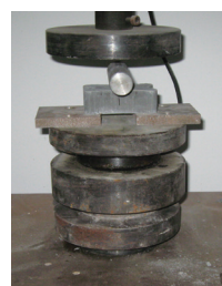
横方向強度試験の状況
