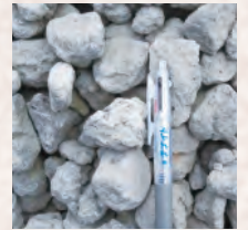
デナイトSEとセメントを混合した路盤材▲
