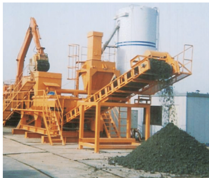
建設発生土改良プラントによる改良状況
