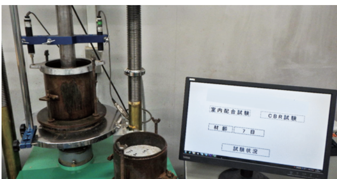
CBR貫入試験
